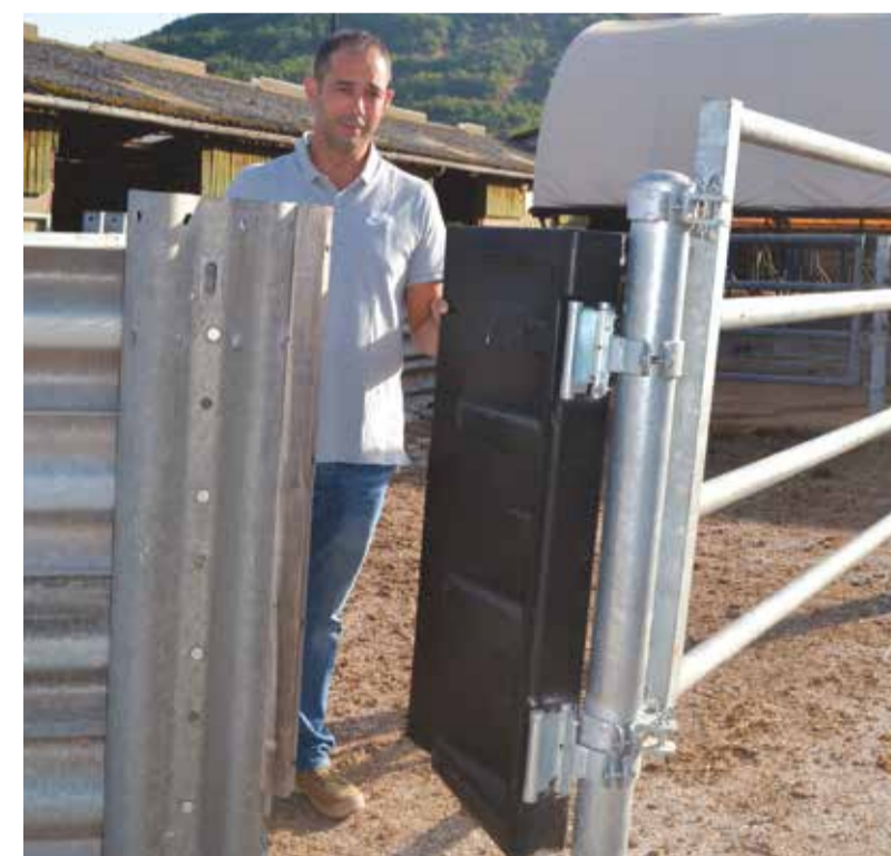
La porte automatique permet à l'éleveur d'entrer et de sortir rapidement du couloir de contention, en la poussant tout simplement.
